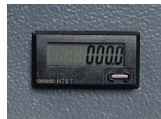
L'horocompteur enregistre les heures de service du moteur de tronçonnage
