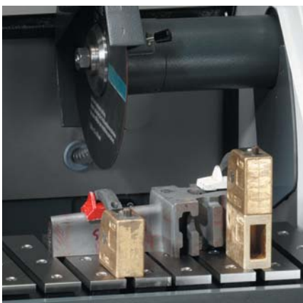
Pour les pièces de forme irrégulière, les outils de serrage vertical sont employés
