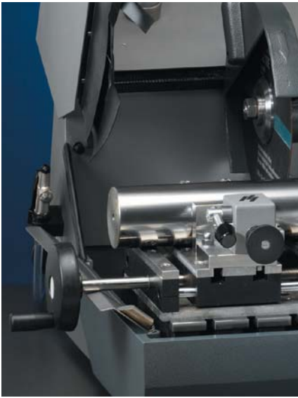
Der einstellbare Trenntisch erlaubt das parallele Trennen
