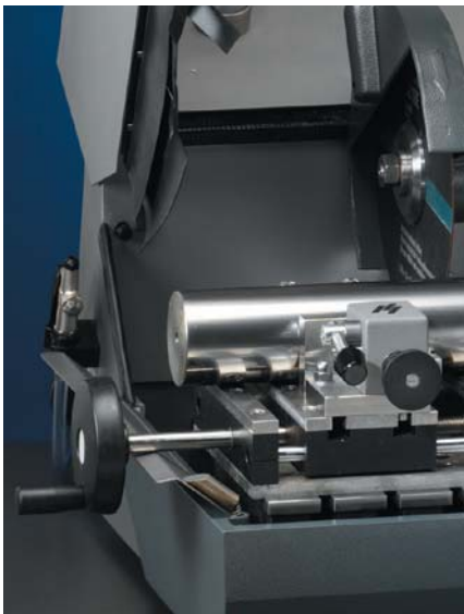
La table de tronçonnage réglable permet le tronçonnage parallèle
