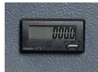
Der Stunden-zähler registriert die Anzahl der Stunden in der der Motor gearbeitet hat
